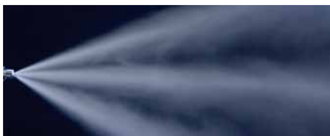
扇形喷嘴的喷射形状
