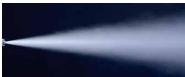
Laval喷嘴的喷射形状
