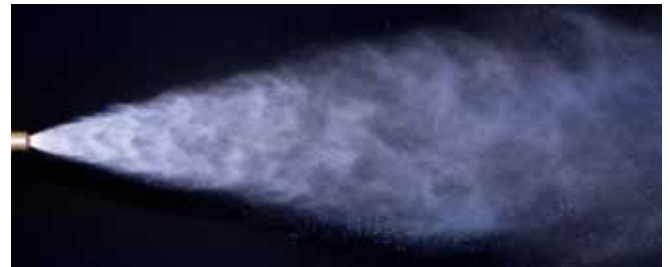
30°MasterNOx喷枪的喷射形状
