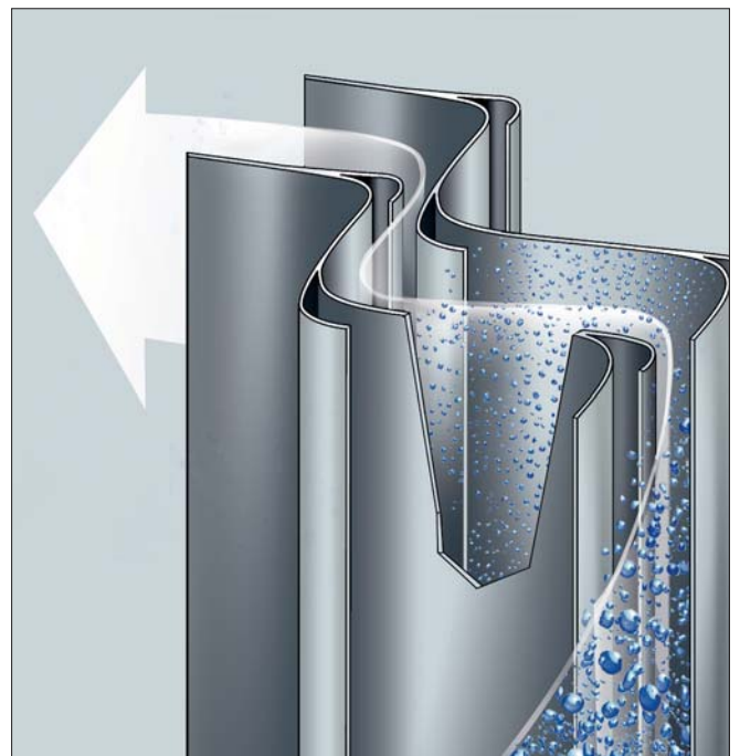
水平型分离器工作原理
