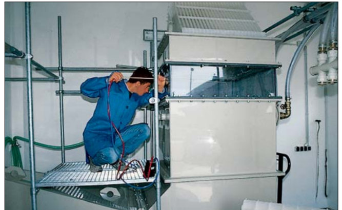
在实验室进行雾滴分离效果检测
