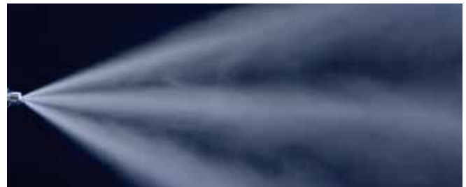
扇形喷嘴的喷射形状
