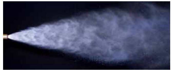
30°MasterNOx喷枪的喷射形状
