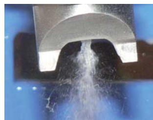
图11：用莱克勒ViscoMist 双流体喷嘴雾化明胶
