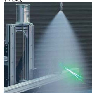
图12：液滴尺寸测量
