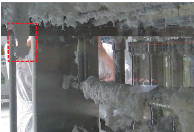
图7：莱克勒PVDF材质的旋转喷嘴MicroWhirly用于泡沫清洗
