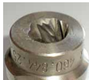
图2：磨损的实心圆锥喷嘴
