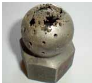
图1：化学腐蚀的喷淋球
