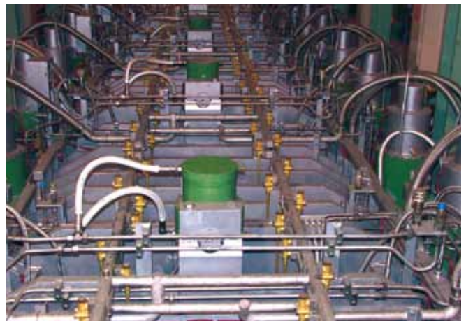
装有Mastercooler SMART喷嘴的水平扇形段
