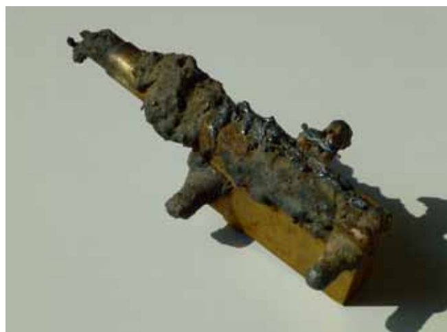
漏钢损坏的气雾喷嘴
