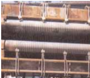
带有进气进水管的小管的气雾喷嘴
