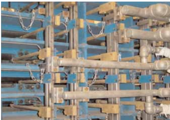
装有Mastercooler SMART喷嘴的板坯连铸机扇形段
