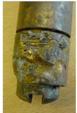
喷嘴喷管没有支撑和定位，导致其与连铸辊接触，引起螺母的机械损伤
