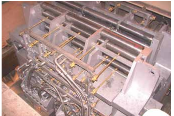
带有错位布置的Mastercooler SMART喷嘴的管路
