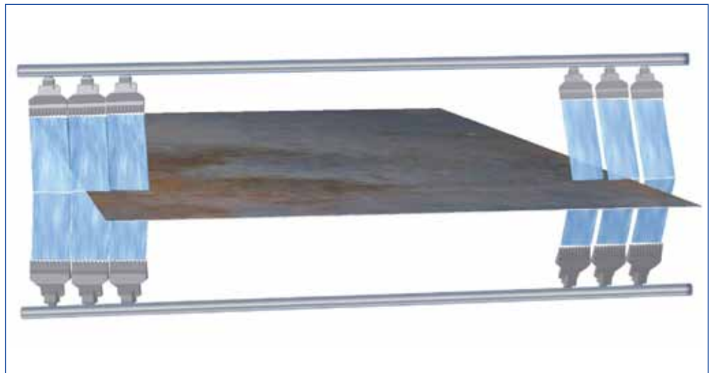
多孔道压缩空气喷嘴带材边部吹扫系统
