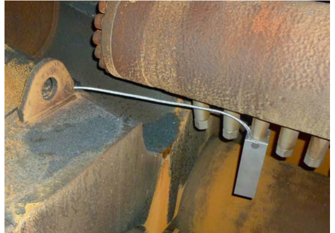
安装示例：安装在除鳞集管上的压力传感器和保护罩
