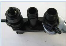
④ Den neuen Pneumatikanschluss aufsetzen. Die eingespritzten Ziffern 1 und 2 dürfen bei der Montage **nicht** nach oben zeigen. Gegebenfalls das Teil drehen. Mittels des Ringschlüssels SW22 den Pneumatikanschluss nach unten auf Position schieben.
