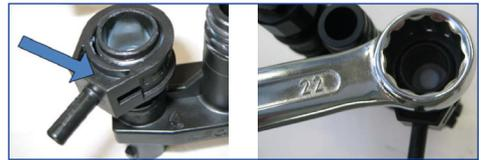
⑤ Die Federn wieder einlegen und die Verschlusskappen mit dem Drehmomentschlüssel anziehen (3Nm).
