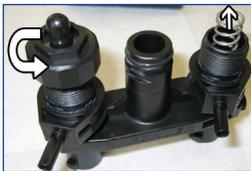
③ Mit dem Ringschlüssel SW22 den Pneumatikanschluss durch vorsichtiges Hebeln nach oben abdrücken.
