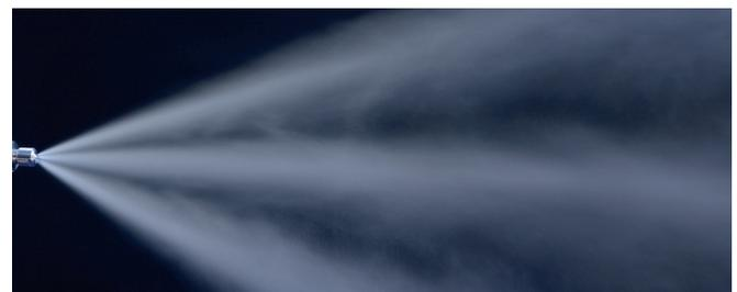
Sprühbild der Flachstrahldüse
