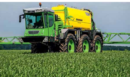
Eine Neuheit von Dammann ist das sensorgestützte Düsensteuerungs-System S-D-S. Es steuert bei großen Arbeitsbreiten variabel die Ausbringung je Sektion des Gestänges.
