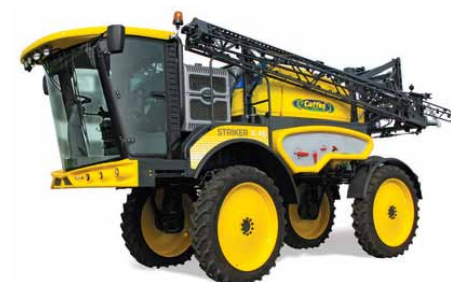
Die Behältergrößen des Striker von Caffini betragen 3 000 und 4 000 Liter und die Arbeitsbreite reicht bis 36 Meter.
