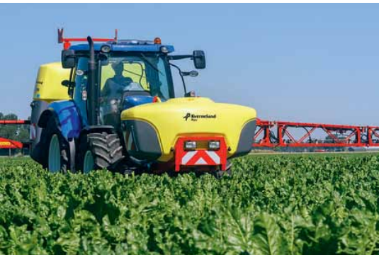
Das Multi-Tank-Management-System von Kverneland macht aus der Kombination der Anbauspritze iXter und der Fronttankspritze iXtra ein leicht zu bedienendes System.
