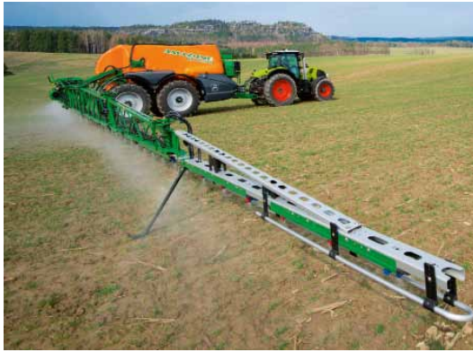
Breite Gestänge erfordern eine sensible Anpassung an die Bodenverhältnisse.
