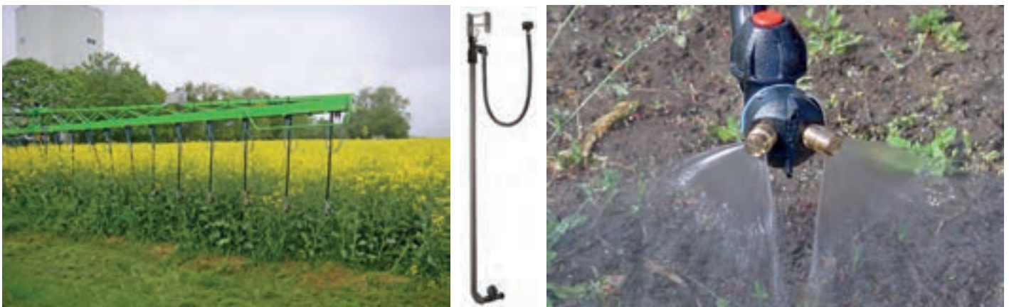
Abb. 1: Dropleg UL im Einsatz bei der Unterblütenbehandlung im Raps. Zwei 90°-Zungendüsen in der TwinSprayCap bilden einen 180°-abwärts gerichteten Flachstrahl aus.
