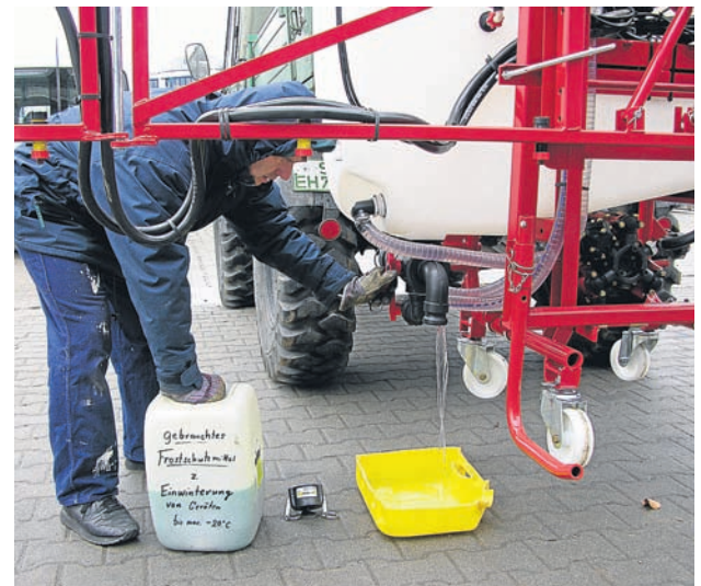
Das Frostschutzmittel wird in Kanister abgelassen und lässt sich erneut verwenden.
