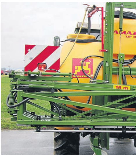
Zur Verkehrssicherheit gehören Warntafeln und eine funktionierende Beleuchtung. Stecker sollten nicht korrodiert sein.
