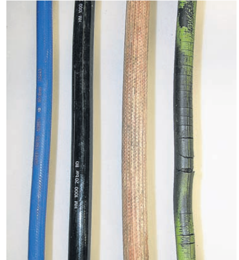
Schläuche altern und müssen auf Risse und Beschädigungen geprüft werden.
