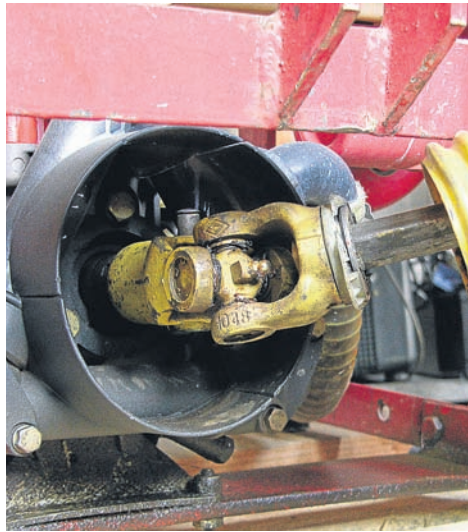
Das Abschmieren betrifft die Zapfwelle und Gelenke des Gestänges. Fotos: Schmidt
