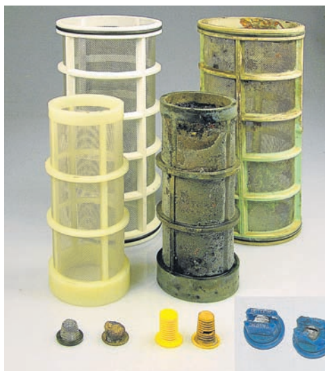
Filter werden gereinigt und bei Bedarf ersetzt. Die Maschenweite des Druckfilters richtet sich nach der kleinsten Düse.
