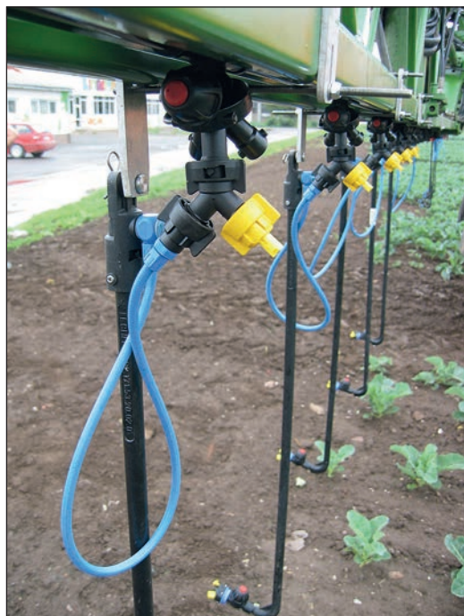
Die Düsenstöcke am Spritzbalken werden jeweils mit einem elastischen Kunststoffrohr verlängert, an deren Enden sich verschiedene Düsen einsetzen lassen.
